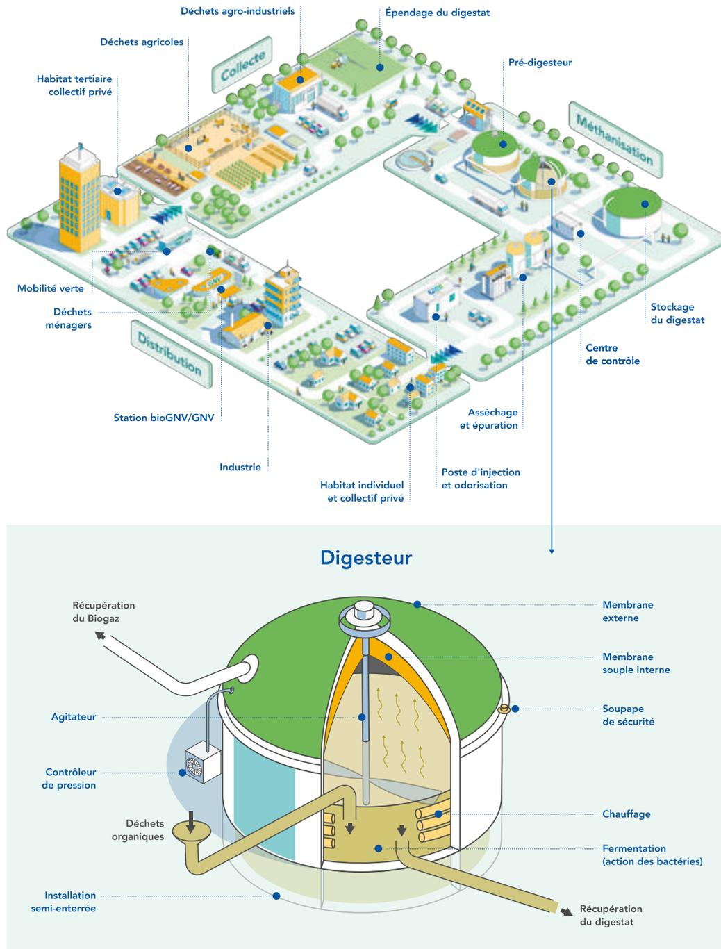
Le biogaz est un gaz 100% renouvelable produit localement et issu de la fermentation anaérobie (méthanisation) de résidus agricoles, d'effluents d'élevage et de déchets des territoires. Après épuration, il atteint le même niveau de qualité que le gaz naturel et peut donc être injecté dans les réseaux et couvrir les besoins des clients en chauffage, cuisson, eau chaude sanitaire et carburant. On l'appelle alors biométhane. Utilisé comme car
