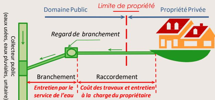
Schéma de raccordement avec regard de branchement sur domaine privé
